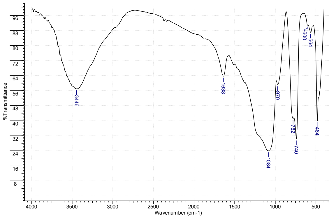
Figura 5 – Espectroscopia na região do infravermelho, biovidro 72 h, demonstrando a presença de bandas entre 560 a 600 cm-1, compatíveis com a presença de hidroxapatita.
