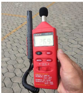
Figura 2: Aparelho de medição de pressão sonora ou decibelímetro
