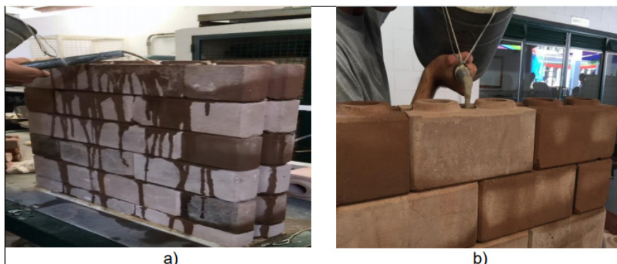
Figura 5: Preparo da mini parede: a) umedecimento; b) injeção da argamassa
