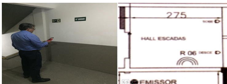
Figura 6: Medição de pressão sonora, equipamento posicionado em R06
