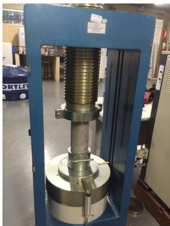
Figura 4 - Ensaio de resistência à compressão
