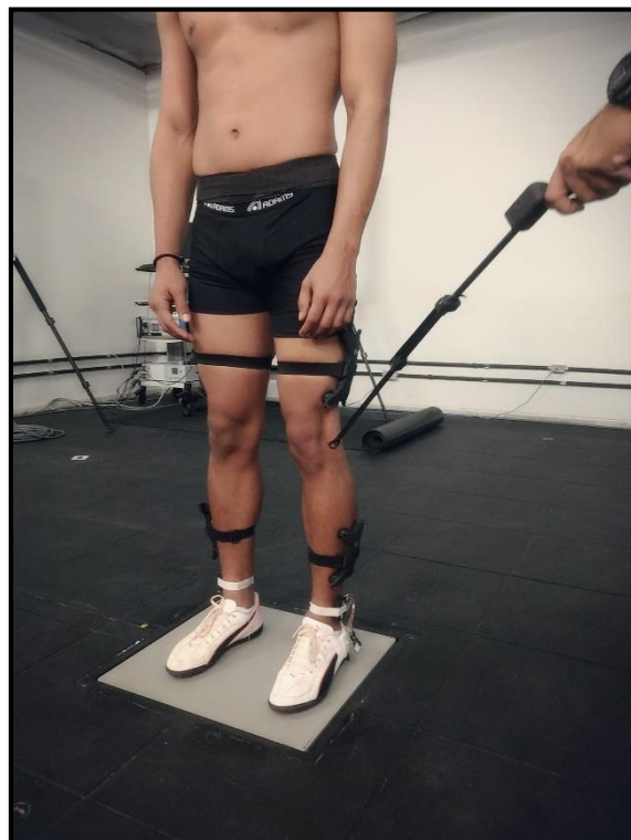
Figura 2 – Utilização do Codamotion Pointer para determinação dos marcadores anatômicos virtuais.
