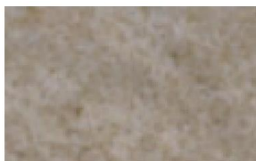
Figura 10 - Exemplo de revestimento cerâmico em tom médio aproximado ( \alpha = 0,423 ).
