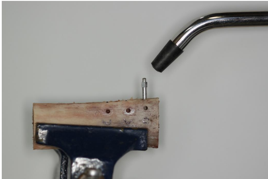
Figura 8 – Realização da análise da frequência de ressonância dos implantes
