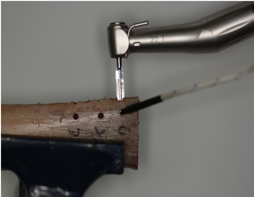
Figura 4 – Localização da sonda do termopar durante a preparação dos leitos para cada grupo
