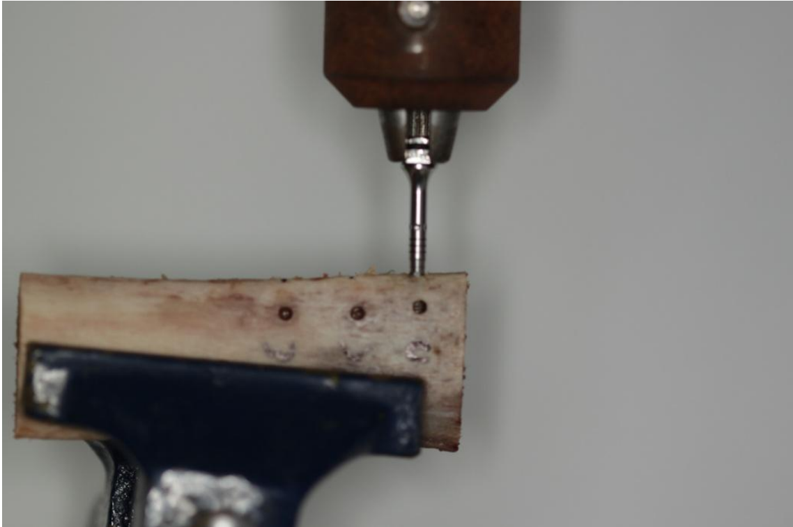
Figura 7– Inserção dos implantes nos leitos, com o uso de um torquímetro digital.
