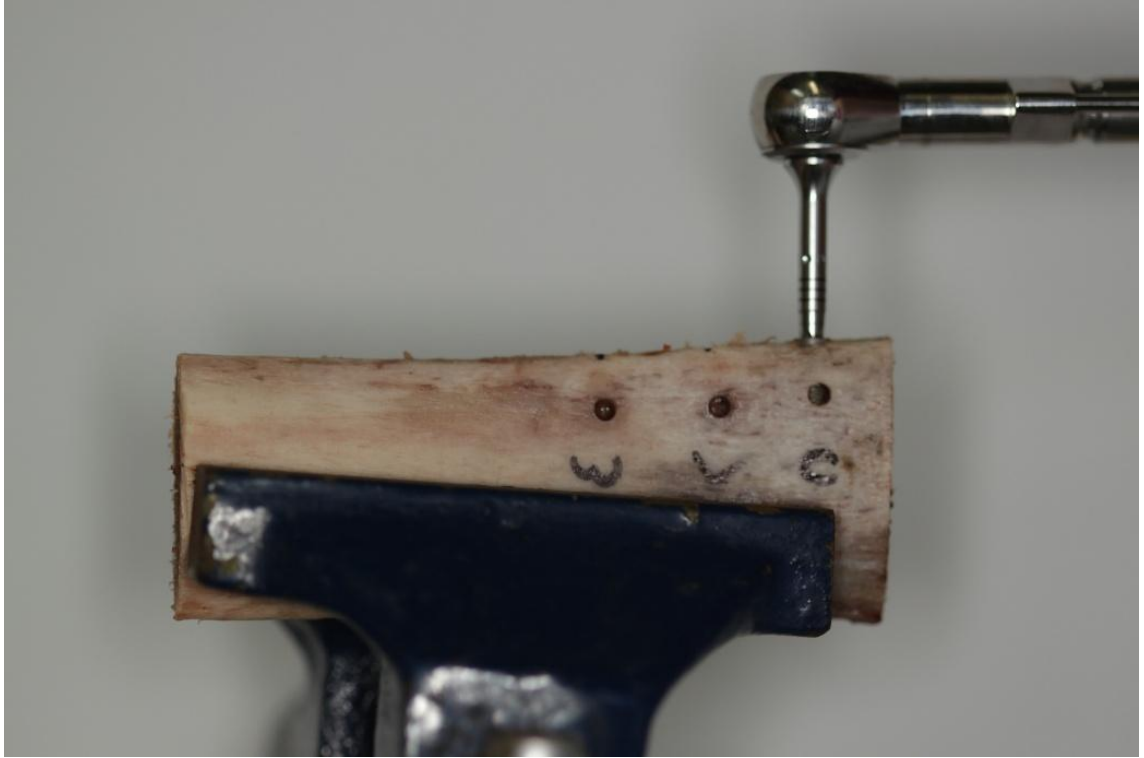
Figura 6 – Inserção dos implantes manualmente nos leitos, com o uso de um torquímetro manual.
