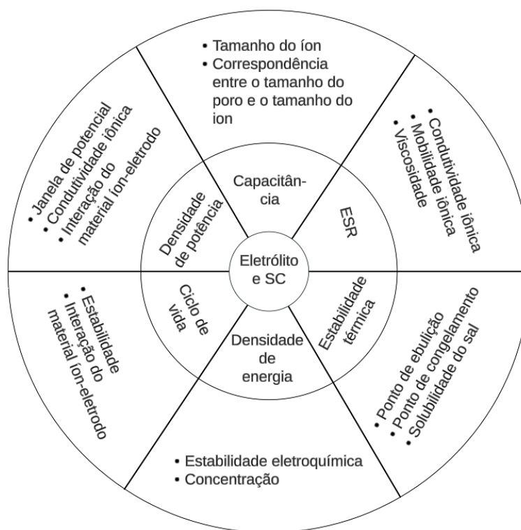
Figura 16 – Eletrólito e impacto no SC (ZHONG et al., 2015)
