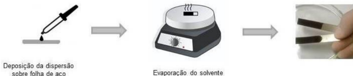
Figura 30 – Esquemático do preparo do eletrodo via casting (ALEXANDRE, 2019)
