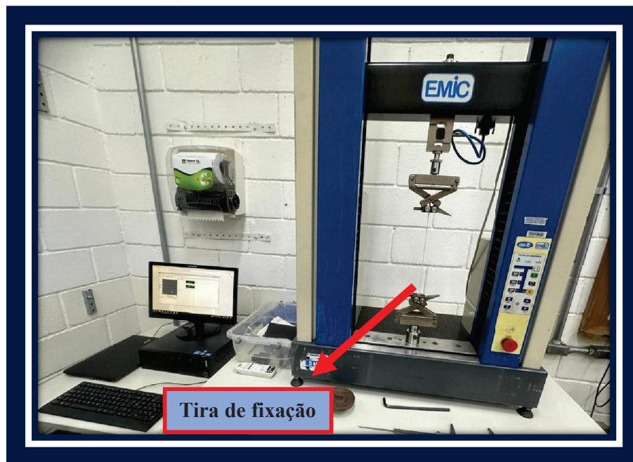
Figura 12 - Amostra da tira de fixação da máscara N95/PFF2 inserida na máquina de ensaio de tração. Belo Horizonte, Minas Gerais, Brasil, 2025
