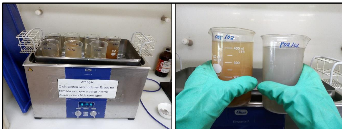
Figura 19 - Solubilização dos óxidos de ferro com auxílio de ultrassom.
