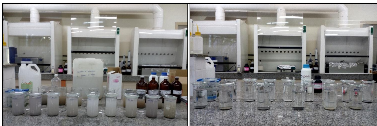
Figura 20 - Dispersão das argilas com Hexametáfosfato de Sódio e Ácido etilenodiamino tetra-acético (EDTA).
