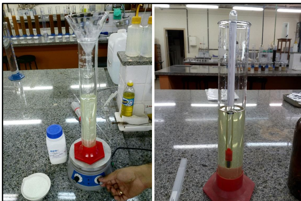
Figura 22 - Preparo e calibração do heavy liquid com densímetro de massa específica 1,000/2,000 g/mL previamente calibrado para 2,3 g/mL.
