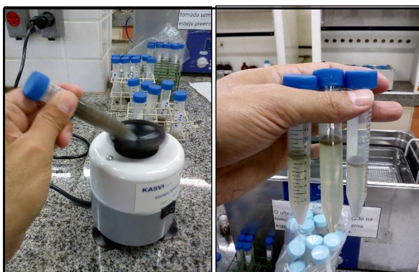
Figura 23 - Separação densimétrica dos fitólitos com heavy liquid .
