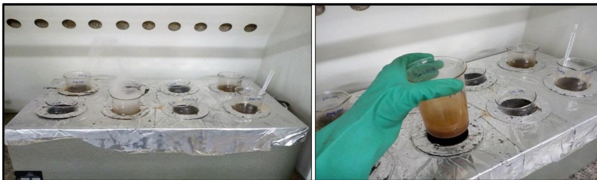
Figura 18 - Oxidação da matéria orgânica na capela de exaustão.
