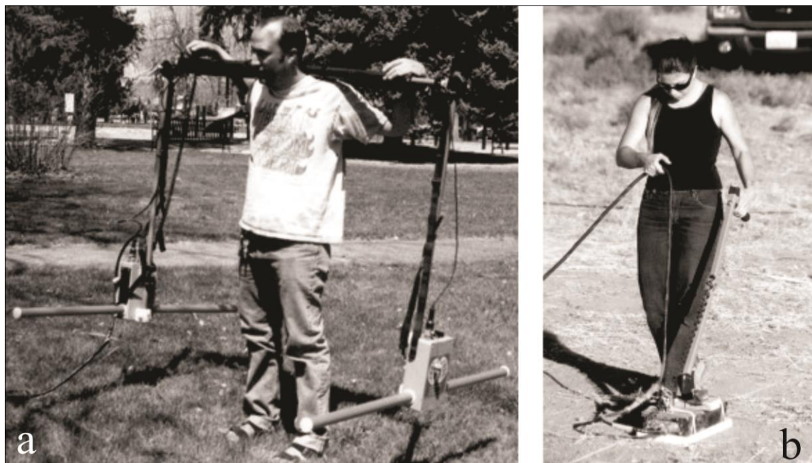
Figura 11. Levantamentos de GPR com antenas de a) 25MHz e b) 900MHz. Fonte: Conyers (2002).
