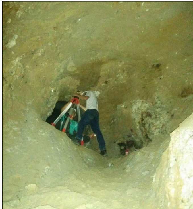
Figura 6. Levantamento topográfico com estação total em galeria secundária do garimpo.
