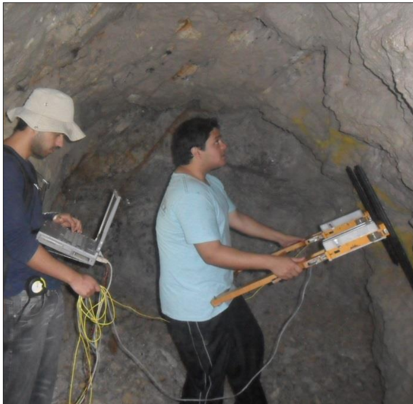
Figura 7. Execução de um perfil com aparelho de GPR em parede de túnel do garimpo.
