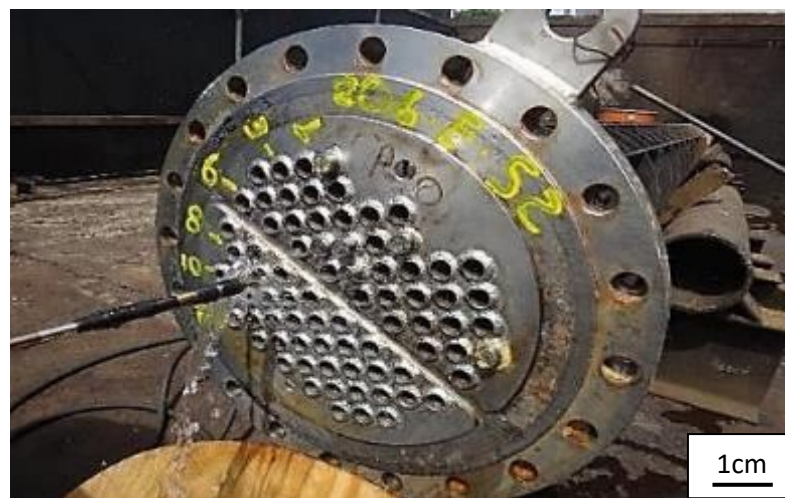
Figura 34 – Ensaio IRIS nos tubos do trocador de calor. Fonte: PETROBRAS, 2022.
