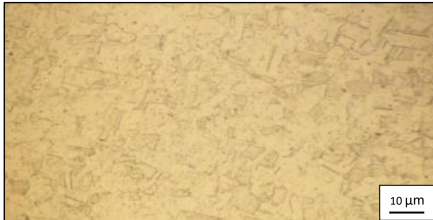
Figura 39 – Micrografia das amostras do tubo do trocador de calor. Fonte: PETROBRAS, 2020.
