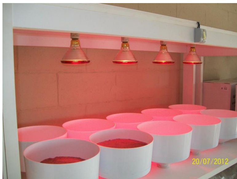
Figura 4.5: Laboratório com colunas cinéticas
