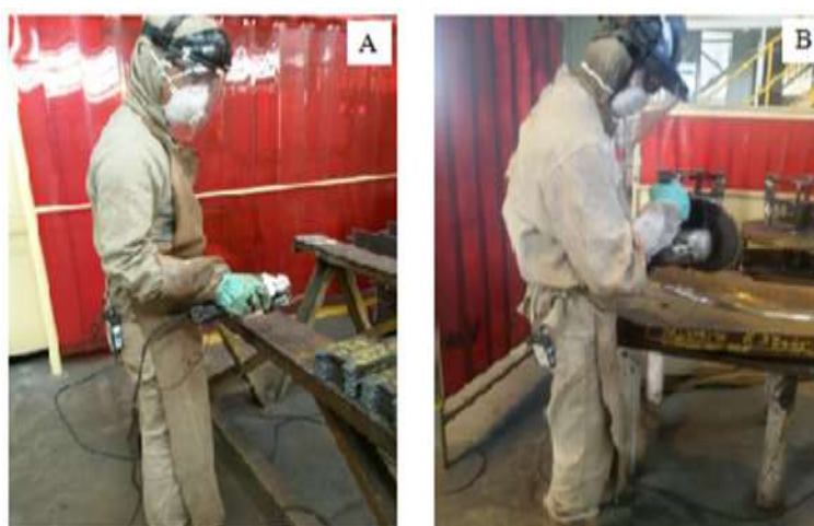
Figura 6: 1ª e 2ª lixadeiras analisadas no estudo de caso. Lixadeira de 4 polegadas (A) e lixadeira de 9 polegadas (B).
