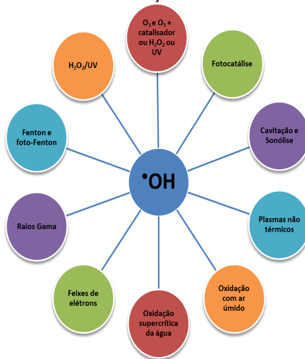
Figura 3.1- Principais formas de obtenção de radicais hidroxilas por Processos Oxidativos Avançados.
