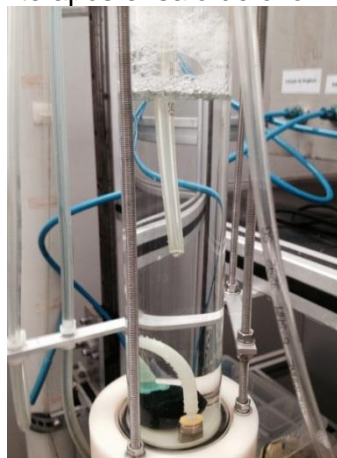
Figura 5.10- Aspecto visual da descoloração do efluente após ensaio de ozonização.
