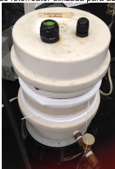
Figura 4.8- Montagem do fotorreator utilizada para as reações de foto-Fenton.
