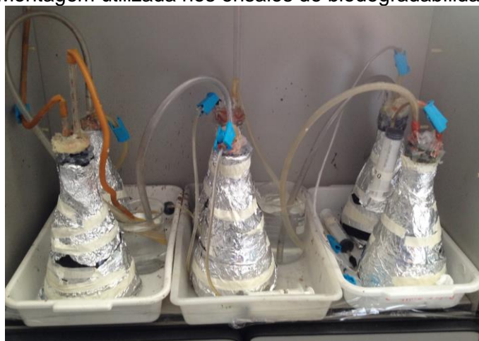
Figura 4.2- Montagem utilizada nos ensaios de biodegradabilidade anaeróbia.
