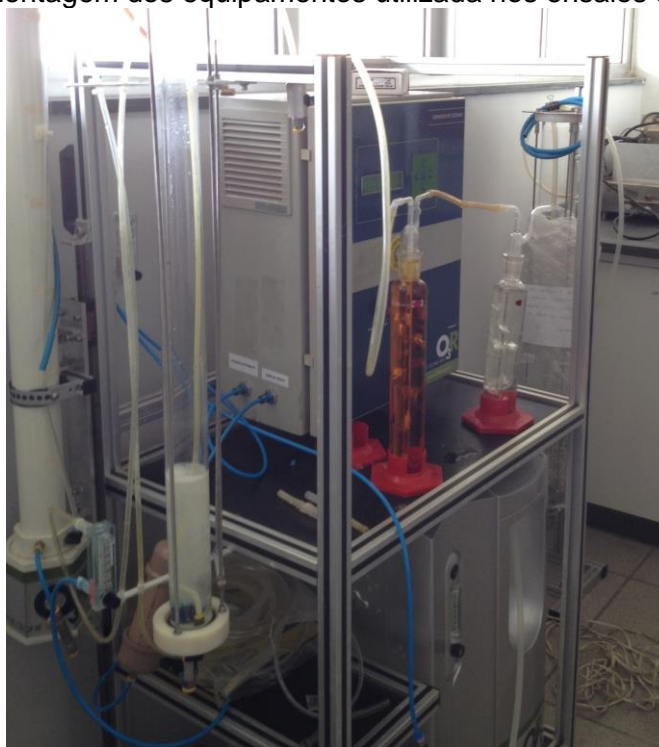
Figura 4.4- Montagem dos equipamentos utilizada nos ensaios de ozonização.
