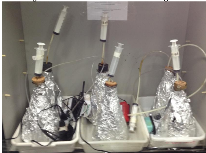
Figura 4.1- Montagem utilizada nos ensaios de biodegradabilidade aeróbia.
