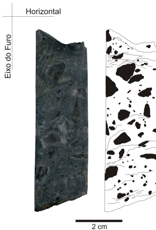
Figura 21. Fotografia e desenho esquemático evidenciando o padrão textural de amostra da porção de topo do diamictito. Notar os planos irregulares que podem ser resultado de cisalhamento durante a sedimentação.
