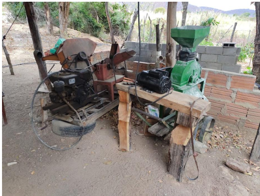
Figura 6: Motor elétrico utilizado no beneficiamento de milho no lote de um assentado
