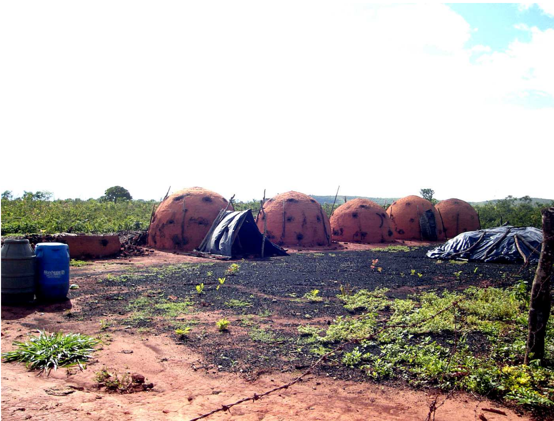
Figura 1.6.– Fornos artesanais para produção de carvão vegetal, localizados na porção nordeste e sudoeste da área. Usa-se como matéria prima arbustos e galhos do cerrado, restos de troncos e eucaliptos.
