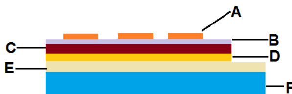
Figura 18 – Vista lateral do dispositivo. A-Contato elétrico superior de Au, B-Camada de PEDOT-PSS, C-Camada ativa, D-TiO 2 anatase, E-ITO e F-Substrato de Vidro.
