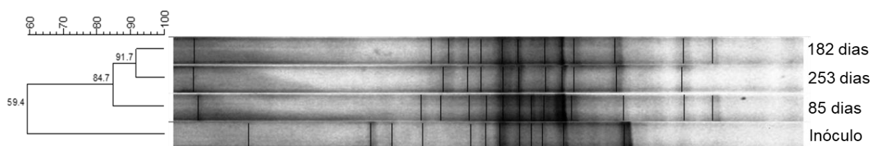
Figura 6.54 – Dendrograma obtido para o perfil de bandas do RBS-Piloto por meio da PCR-DGGE do Domínio Bacteria (coeficiente de similaridade de Dice e método de agrupamento UPGMA)
