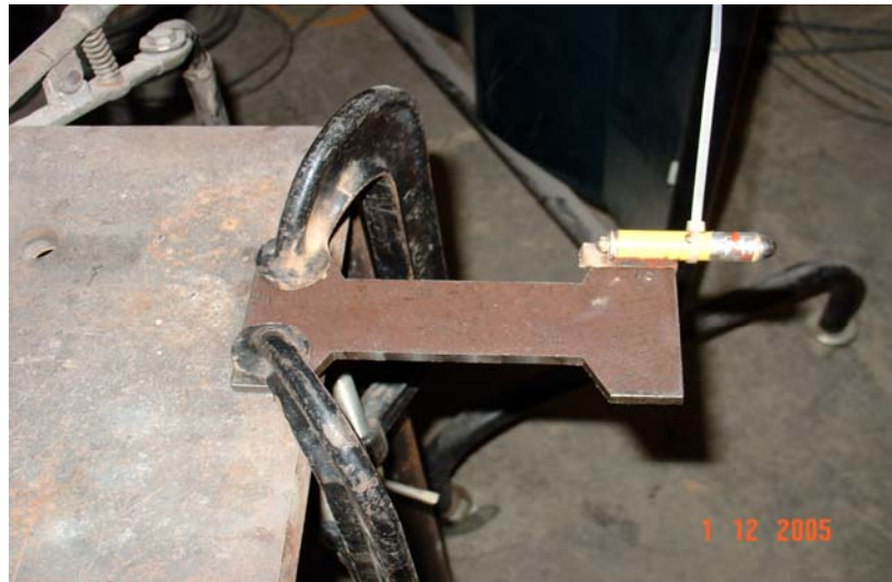
FIGURA 4.5- Corpo de prova fixado a uma bancada e o dispositivo para monitoração das distorções angulares (laser).
