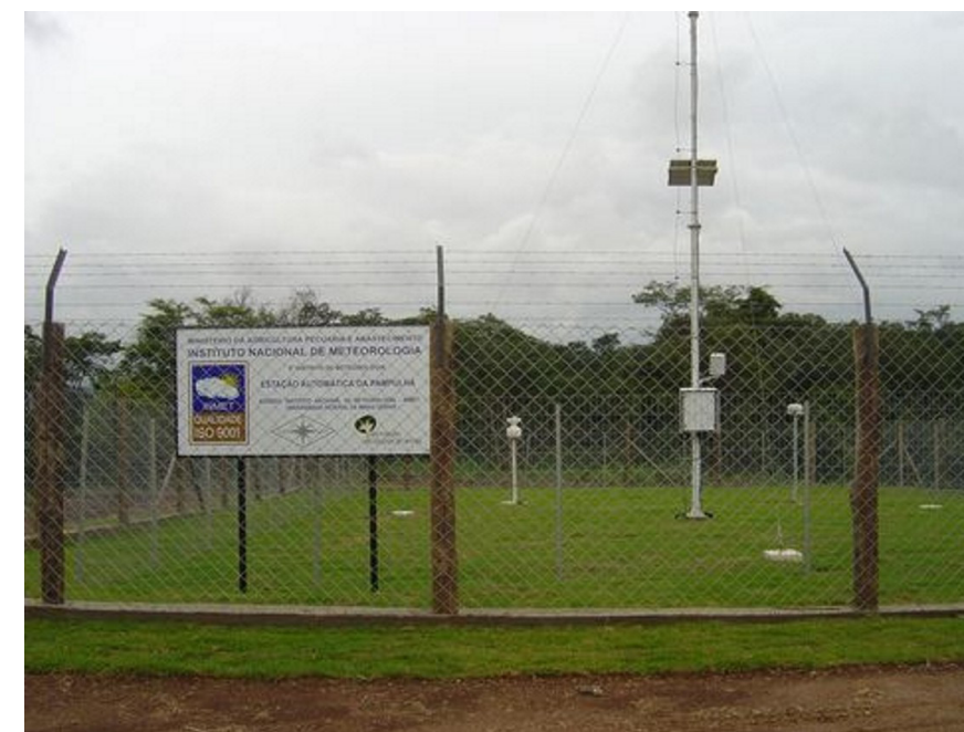
FIGURA 1.2. Estação automática instalada no campus da UFMG em Belo Horizonte - MG.
