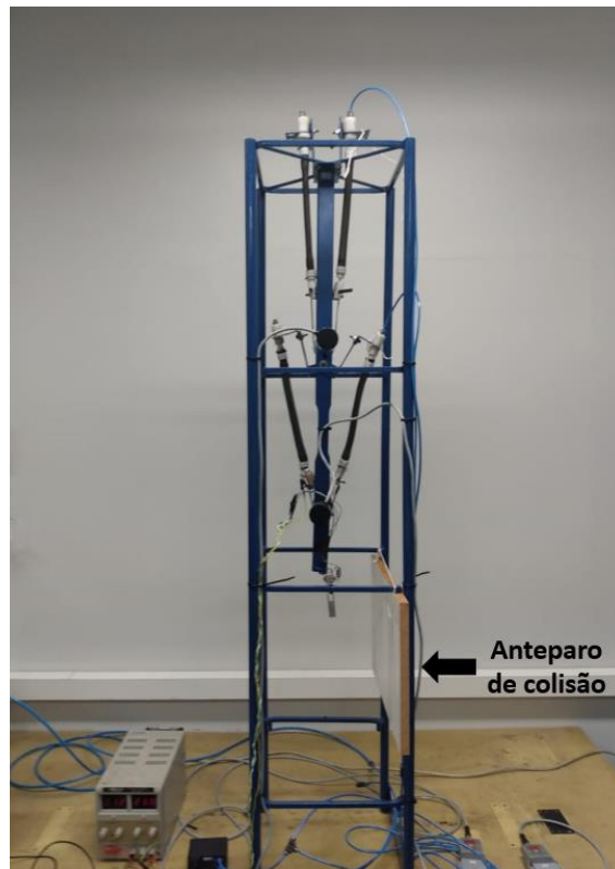
Figura 33 – Manipulador pneumático com destaque para o anteparo de colisão.
