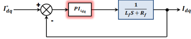
Figura 4.11: Diagrama em bloco da malha interna de controle de corrente do CLR.
