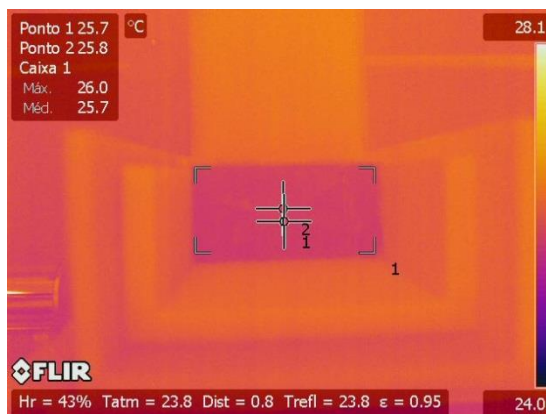
Figura 4.27 – Termograma com a ferramenta “ponto”.
