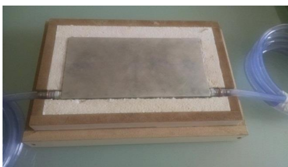
Figura 4.20 – Placa fria instalada na base da bancada.
