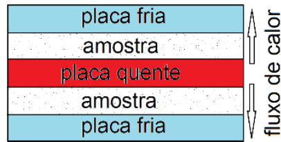
Figura 4.13 – Diagrama fluxo de calor.
