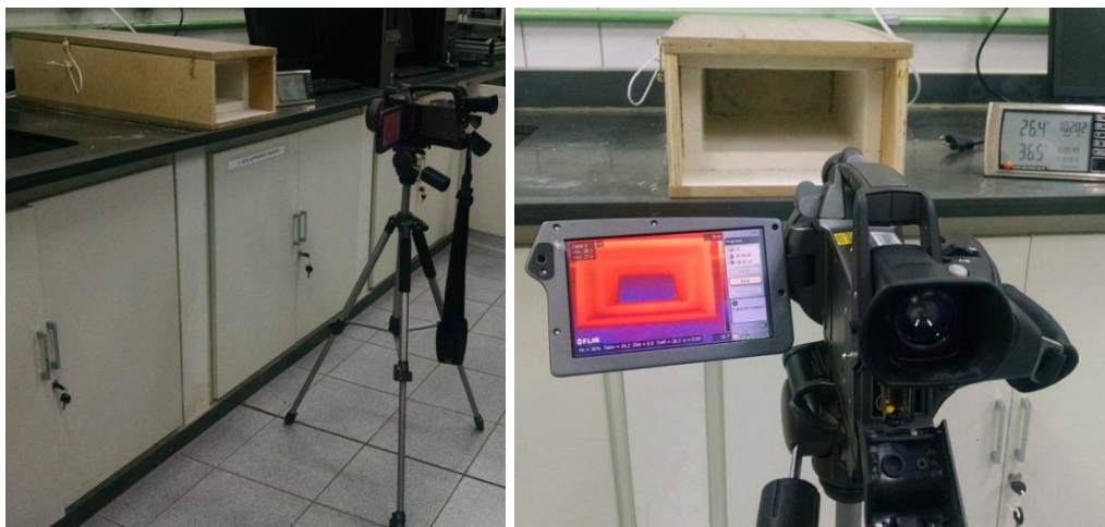
Figura 4.30 – Câmera termográfica registrando imagens.
