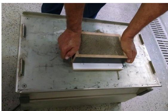
Figura 4.11 – Material sendo vibrado.
