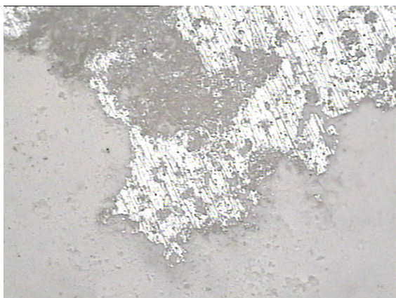
Figura 5.27: Micrografia óptica de um filme de CGO não aderente sobre substrato de YSZ (aumento de 400x)
