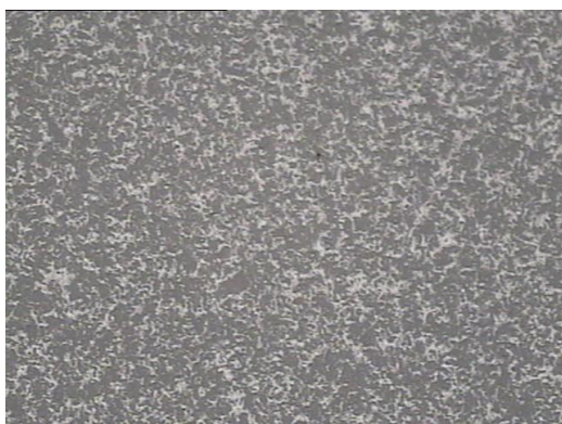
Figura 5.25: Micrografia óptica de uma pastilha de YSZ Tosoh tratada com lixa 220 (aumento de 400x)
