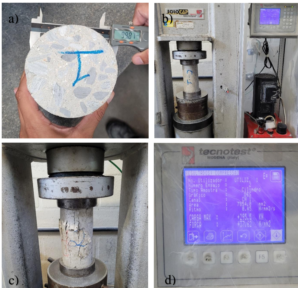
Figura 18: Ensaio de resistência à compressão axial: a) medição das dimensões de corpo de prova por meio de paquímetro; b) posicionamento de corpo de prova em prensa hidráulica; c) ruptura de corpo de prova; d) display eletrônico para leitura dos dados de ruptura
