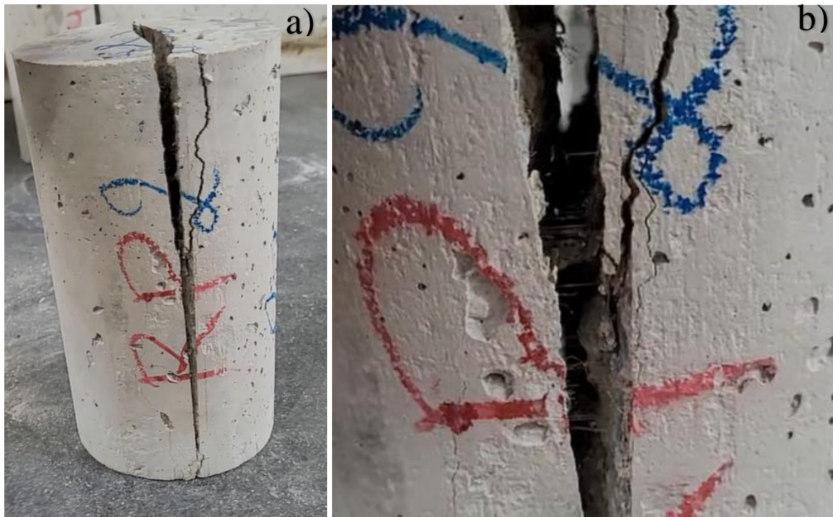
Figura 31: Corpo de prova da dosagem RP após o ensaio de tração por compressão diametral: a) corpo de prova logo após o rompimento; b) fibras ligando as duas metades do corpo de prova
