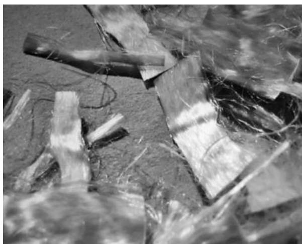
Figura 8: Microfibras de polipropileno monofilamentares
