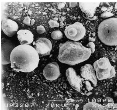
Figura 4: Morfologia do resíduo de catalisador de petróleo obtido na BP Oil España
