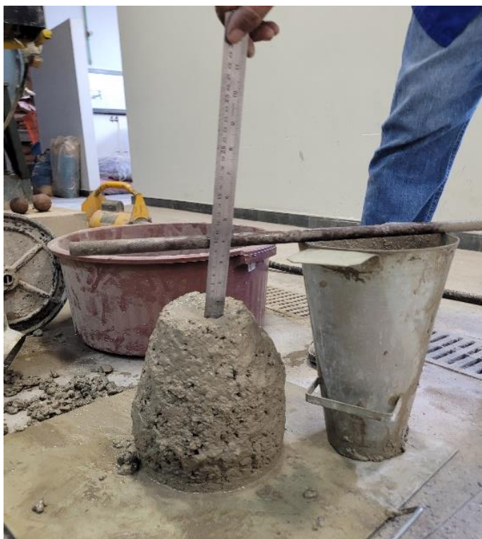
Figura 16: Execução do ensaio de abatimento de tronco de cone
