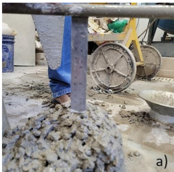
Figura 27: Ensaio de tronco de cone para os concretos no estado fresco nas dosagens C, R, P e RP:
