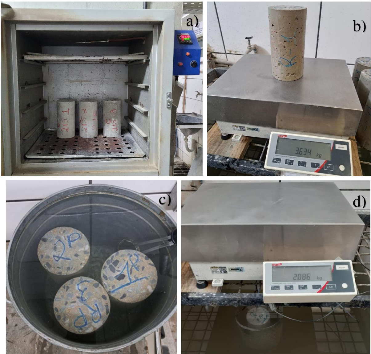
Figura 21: Ensaio de absorção de água, índice de vazios e massa específica: a) secagem das amostras em estufa; b) pesagem das amostras; c) imersão em água levada à ebulição; d) pesagem das amostras em balança hidrostática.
