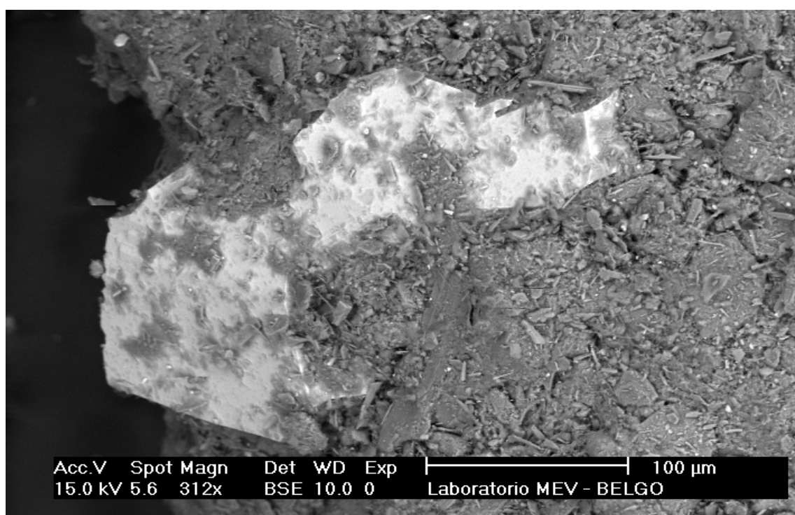
Figura 5.15 – Fotomicrografia obtida em MEV-BSE de um fragmento da fração <2,00 mm e >0,15mm do serpentinito. Trata-se de uma visão localizada mostrando o aspecto fibroso da clinocrisotila detectada na DRX. Nota-se a presença de um cristal de magnetita (mais claro) que explica a análise de FRX que detectou o elemento químico ferro em concentração média. A rugosidade e porosidade do fragmento é um aspecto notável na amostra analisada. Aumento de 312X.
