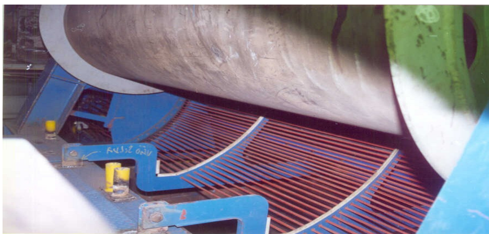
Figura 3.6 – Etapa de segregação no SSW (Segregation Slit Wire implantado na Usina de Monlevade).
