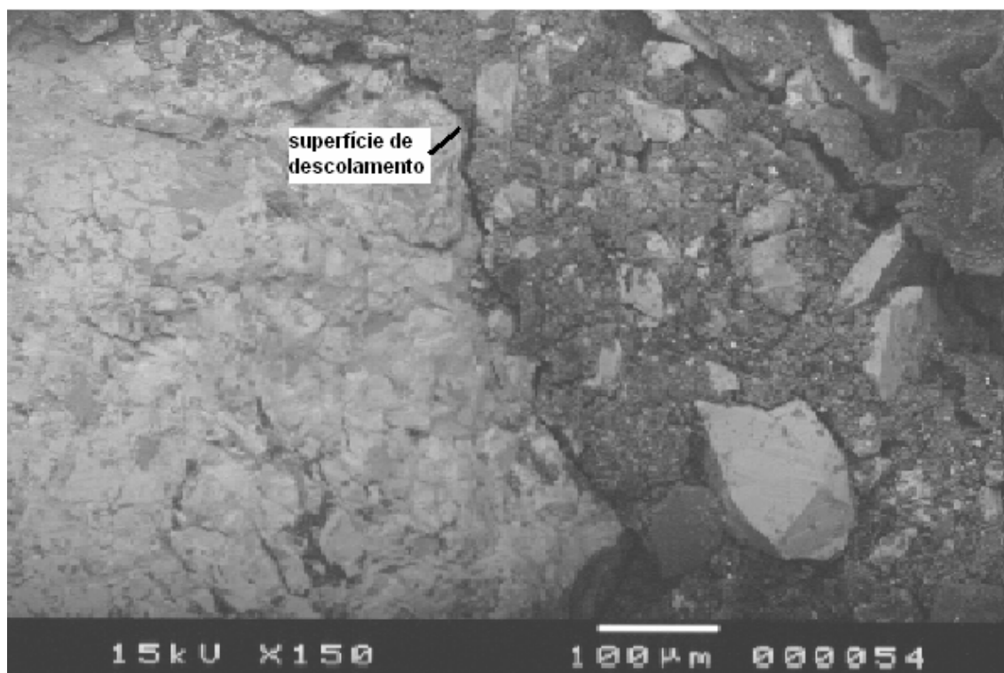
Figura 5.41- Imagem MEV mostrando a superfície de descolamento da película no núcleo devido sobretudo à característica de baixa porosidade intragranular do minério Andrade. Aumento de 150X.
