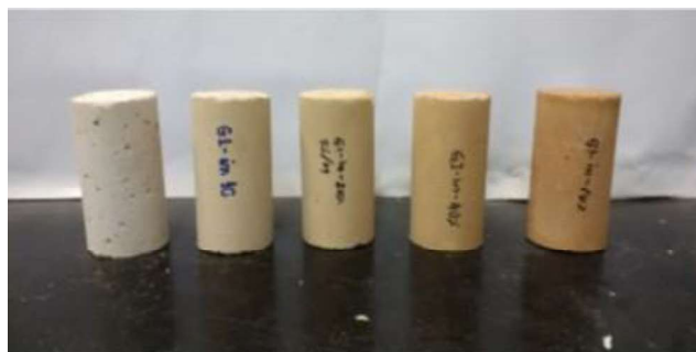
Figura 2: Coloração das argamassas com RMF em comparação com a argamassa referência (esquerda).
