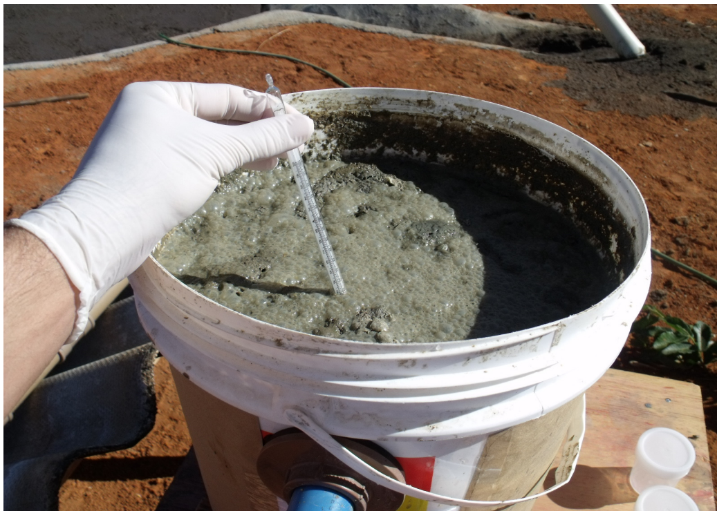
FIGURA 6 – Medição de temperatura no efluente. Fonte: Da autora.
