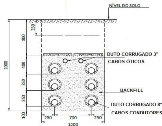
Fig. 10. Seção típica do banco de dutos
