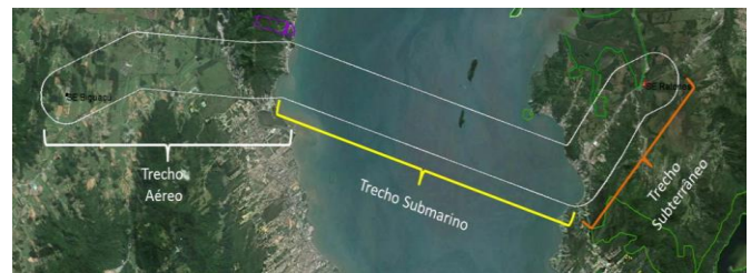
Fig. 1. Vista de Planta da linha híbrida
