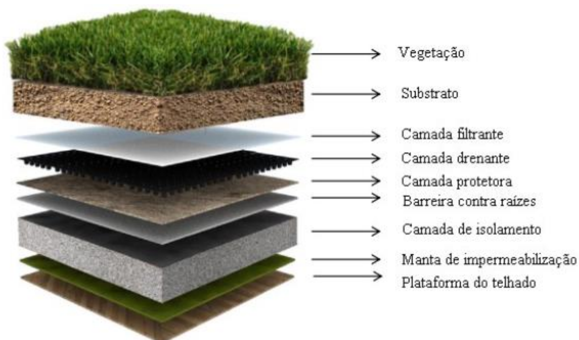
Figura 17 - Camadas de um telhado verde
