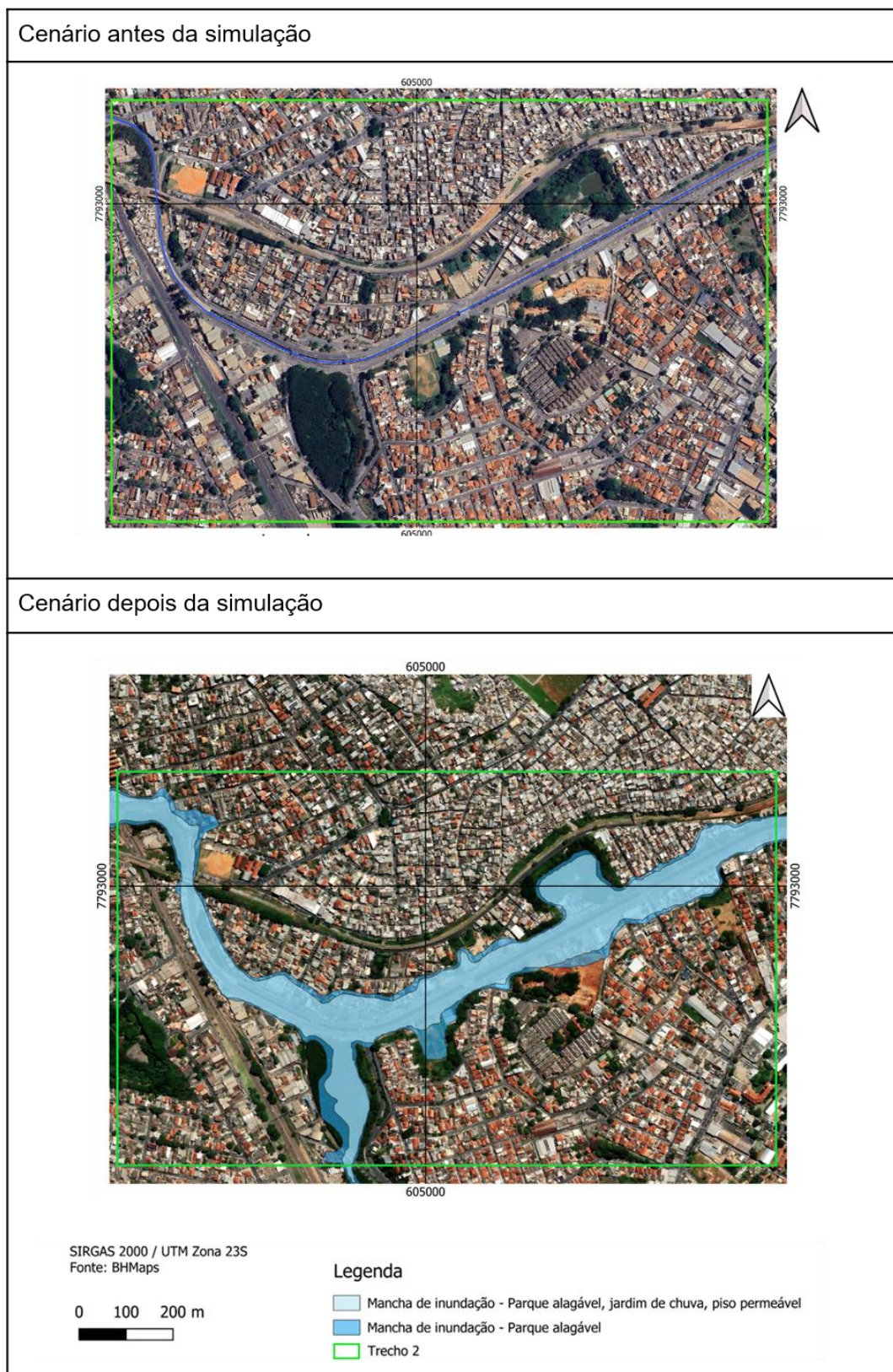
Figura 71 - Mapa de manchas de inundação com simulação do cenário com infraestruturas nos trechos 2
