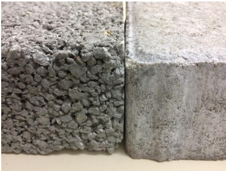
Figura 20 - Comparação da porosidade do calçamento permeável com o calçamento de concreto
