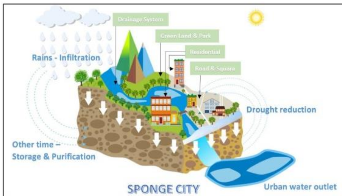
Figura 24 - Modelo conceitual de uma cidade esponja com os mecanismos para a absorção da água da chuva
