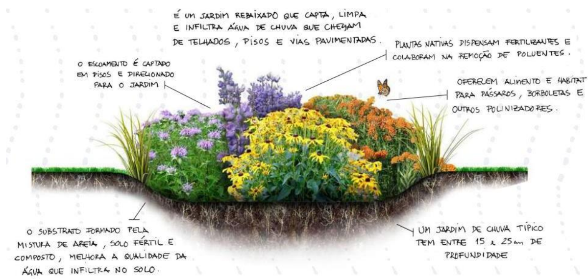
Figura 10 - Estrutura de um jardim de chuva
