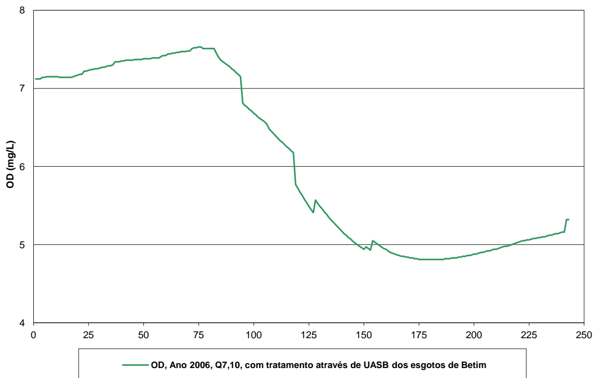
GRÁFICO 8.4 - Valores simulados da concentração de oxigênio dissolvido em função da distância (km) para o ano de 2006, com Q_{7,10} e com implantação de estação de tratamento em nível secundário intermediário (UASB) para a sede urbana de Betim. Cálculo de K_2 por ARCEIVALA para o Rio Paraopeba e tributários, com K_1=0,17 \text{ dia}^{-1} , com demanda completa de oxigênio.
