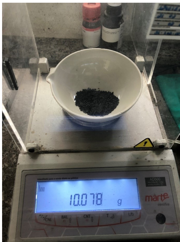
Figura 2: Amostra de carvão preparada para regeneração térmica (Teste 06).
