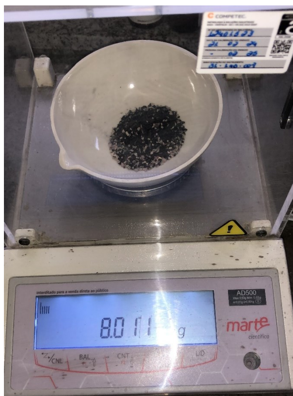
Figura 3: Amostra de carvão após teste de regeneração térmica (Teste 06), com aspecto visual esbranquiçado.
