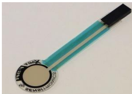
Figura 74 - Imagem do sensor ThruMode RSR ½” da Sensitronics®
