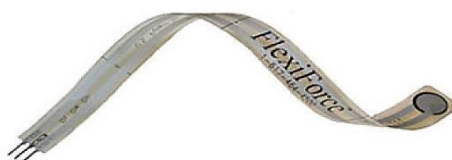
Figura 77 - Imagem do sensor FlexiForce A201 da Tekscan®
