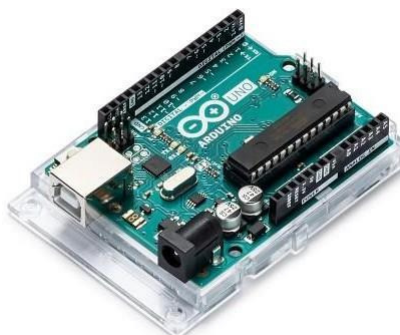
Figura 79 - Plataforma de desenvolvimento Arduino UNO
