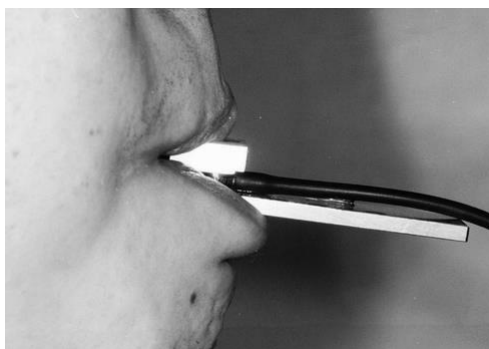
Figura 12 - Medição da força de selamento labial usando o medidor com célula de carga
