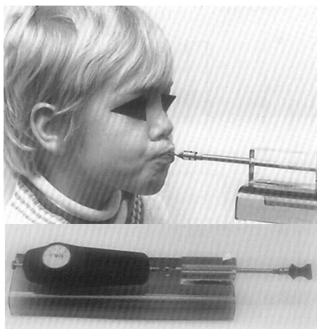
Figura 11 - Medição da força labial utilizando dinamômetro
