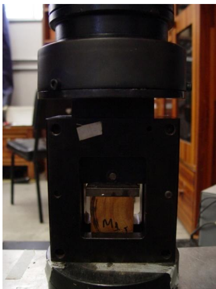
FIGURA 3.10 – Ensaio de cisalhamento.
