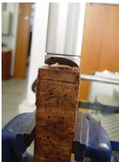
FIGURA 3.2 – Utilização do equipamento pilodyn em laboratório.
