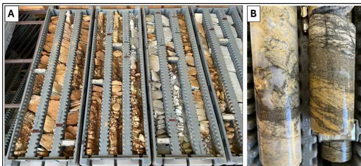
Figura 7: A - Testemunhos de sondagem disposto em caixas plásticas próprias para o armazenamento. B - Zona mineralizada dos testemunhos de sondagem.
