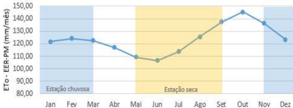
Figura 6 - Médias mensais da ETo na Bacia Amazônica Brasileira estimadas pelo modelo EER-PM para o período projetado (2006-2050).
