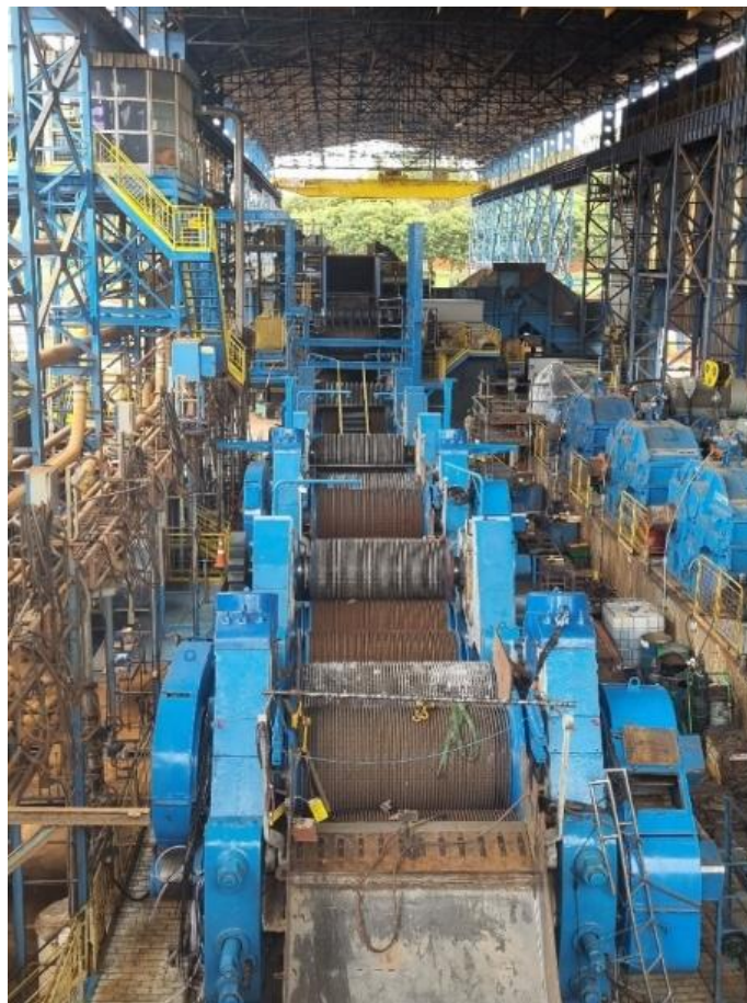
Figura A-2 – Imagem da remontagem dos ternos de uma moenda durante a entressafra. (Figura do autor)
