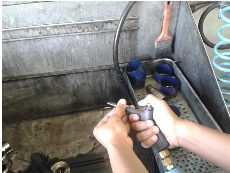
Figura 6 – Trabalhador realizando a limpeza do bico injetor
