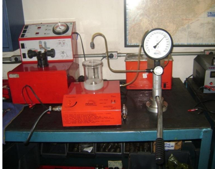
Figura 2 - Máquina que realiza os testes dos bicos injetores denominada “controlador do bico injetor”
