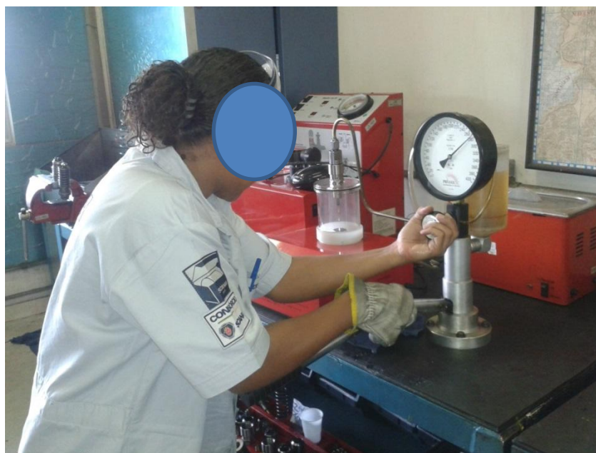
Figura 12 – Trabalhador realizando o teste do bico injetor (simulação da lenta)
