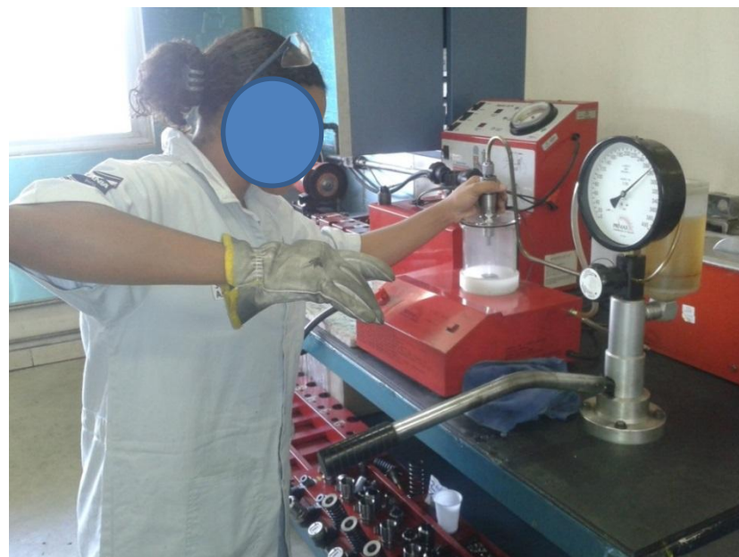
Figuras 10 e 11 – Trabalhadora realizando o teste do bico injetor
