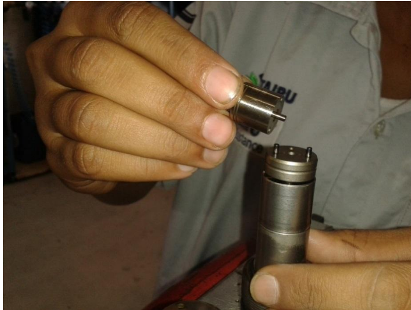
Figura 7 – Trabalhador realizando a montagem do bico na base para colocá-lo na máquina para fazer o teste
