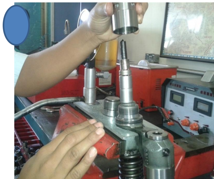
Figura 5 – Trabalhador retirando manualmente o bico injetor
