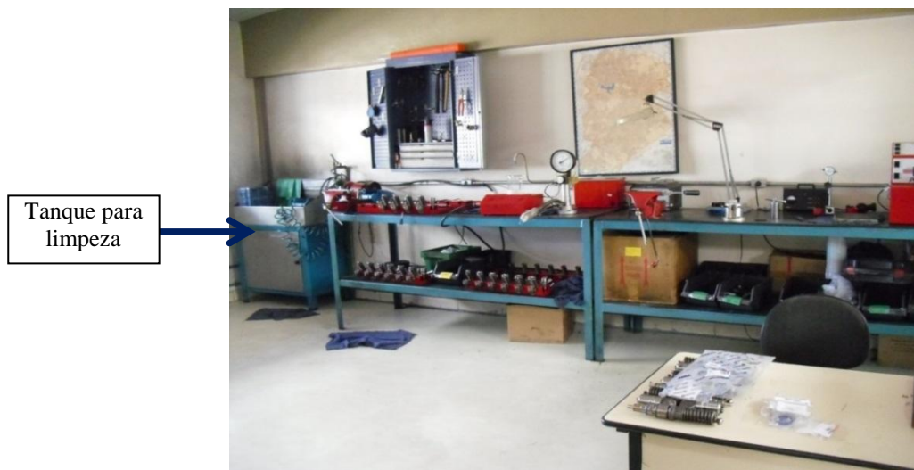
Figura 3 – Bancada de trabalho e o tanque onde é realizada a limpeza dos bicos
