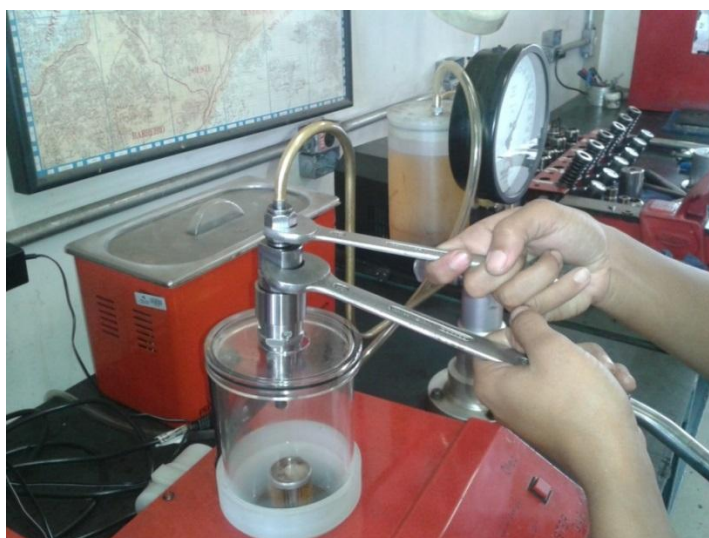
Figura 9 – Trabalhador realizando o aperto da base de teste na máquina para fazer o teste do bico
