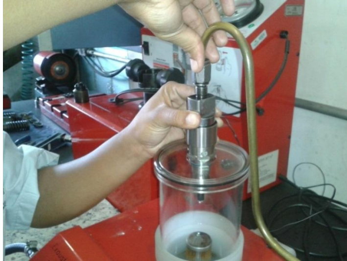
Figura 8 – Trabalhador montando a base de teste com o bico na máquina para fazer o teste
