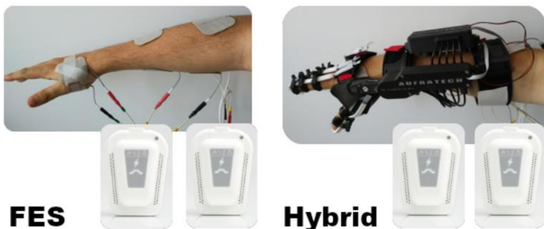
Figura 12: Órtese híbrida Grasphyb , com FES e sistema mecânico de trava
