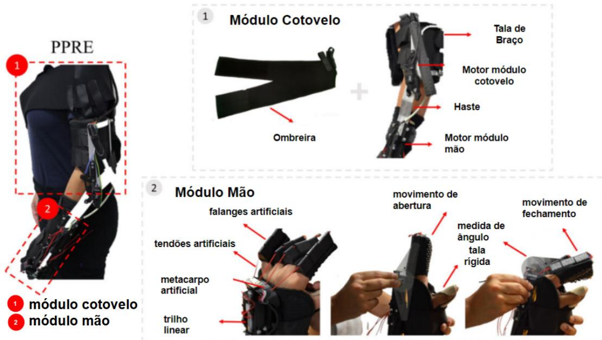
Figura 14: Órtese PPRE, Módulo 1 (cotovelo) e Módulo 2 (mão)
