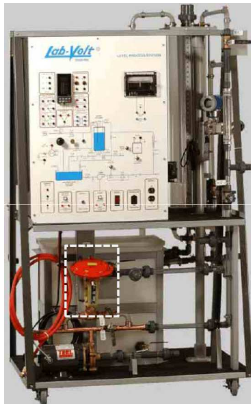
Figura 5.8: Sistema de controle de nível.
