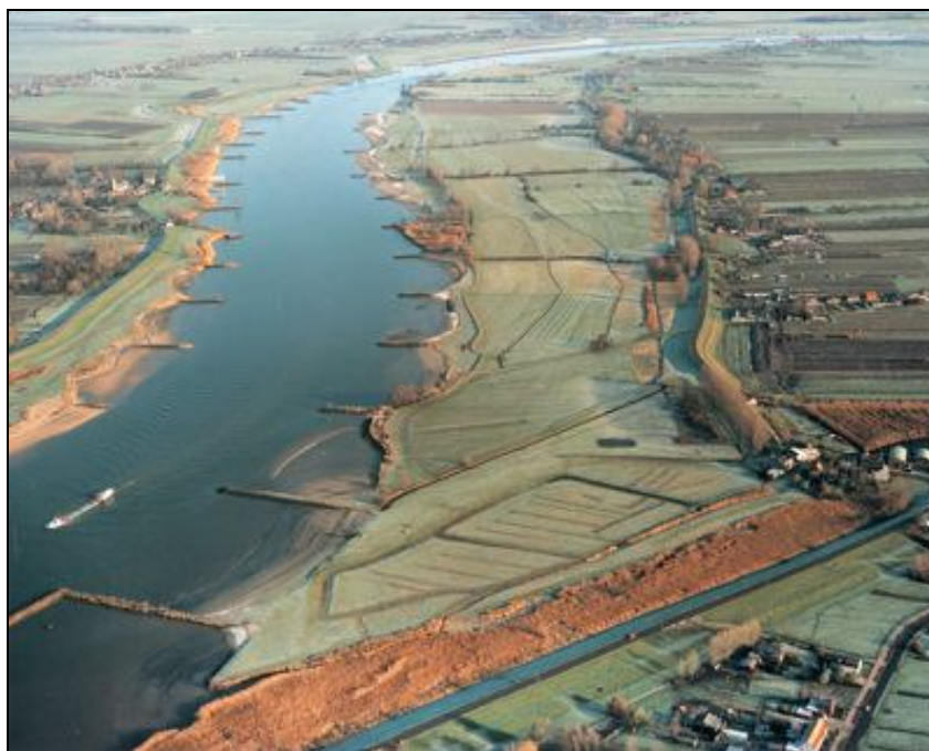
Figura 4.12 – Espigões no rio Lek, Holanda. Fonte: Geological Survey of Ireland, 2008.
