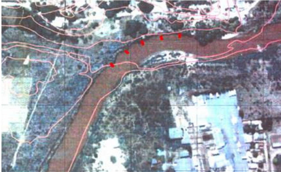
Figura 5.30 – Localização esquemática da implantação dos espigões.
