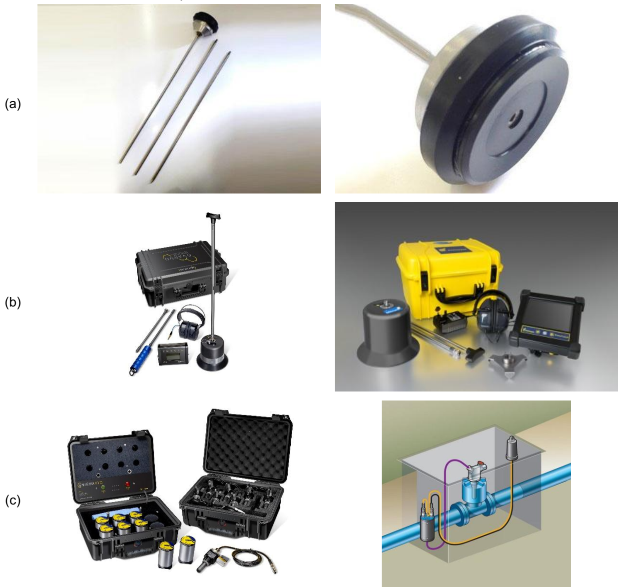
Figura 12 – Principais métodos acústicos: a) Haste de escuta mecânica; b) Geofone eletrônico; c) Correlacionador de ruído com hidrofone.
