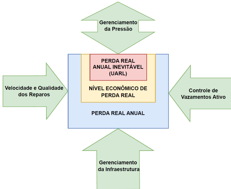
Figura 9 – Quatro atividades básicas no gerencialmente de vazamentos.
