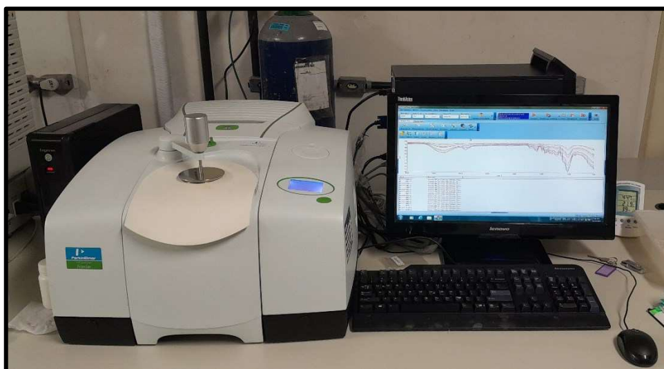
Figura 18 - Espectrômetro Perkin Elmer®, modelo Frontier Single Range.
