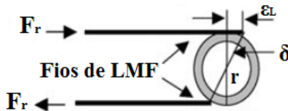
Figura 3.4 – Movimento gerado pelo fio de LMF. Adaptado de EPPS e CHOPRA (2001).
