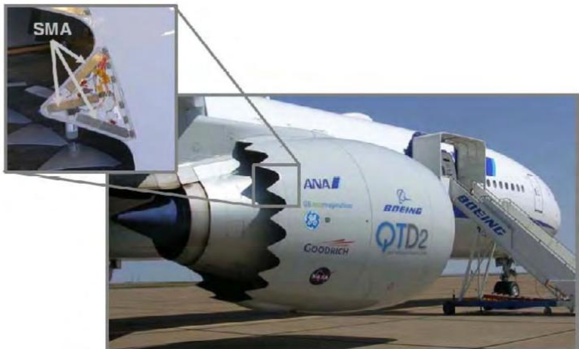
Figura 2.15 – LMF ( Shape Memory Alloy – SMA) usada na redução de ruído da turbina (HARTL et al., 2010).
