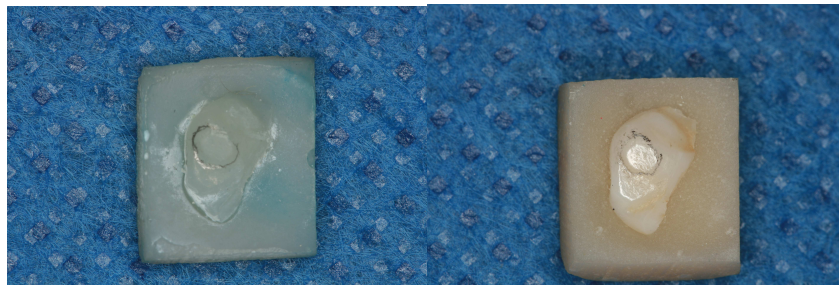
Figura 25: modelo em resina Flow (esquerda) e dente original pré-molar (direita). A área de desgaste está demarcada.
