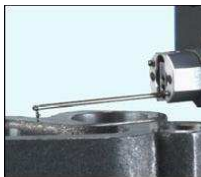
Figura 26: Aparelho Perfilômetro (à esquerda) e ponta TK600 (à direita) Fonte: http://www.dees.ufmg.br/biomec/projetos/proj_Desgaste.html
