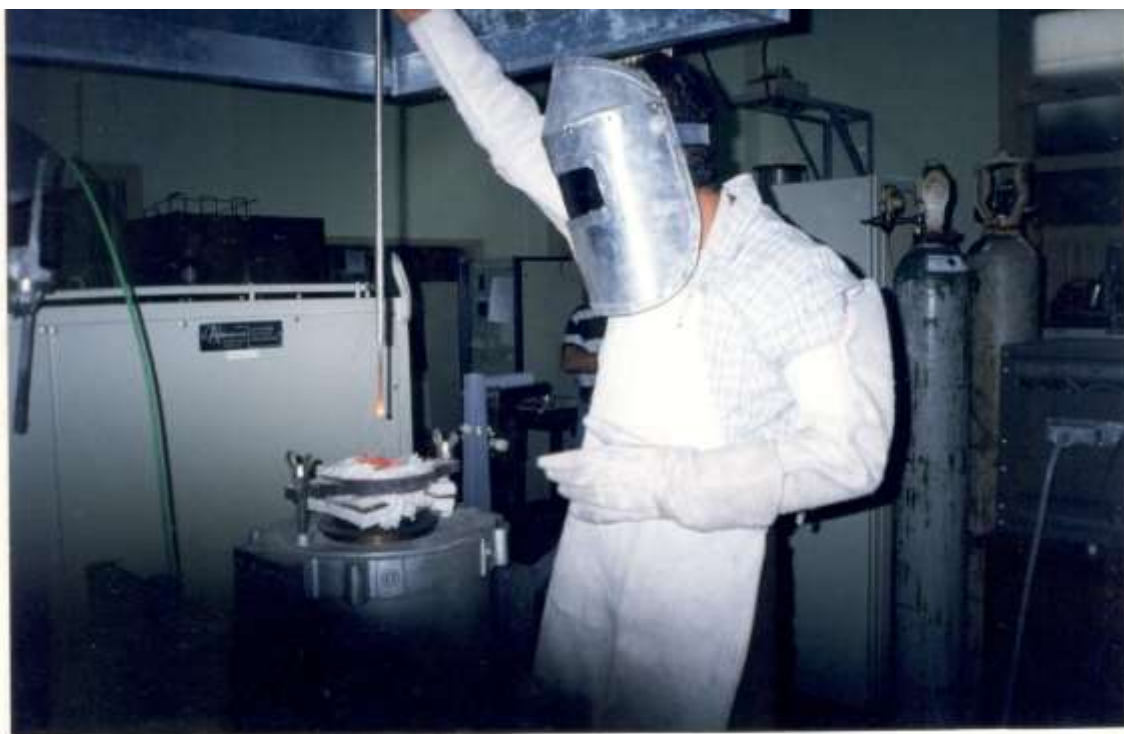
Figura 5. 4 - Amostragem de gusa líquido, amostrador a vácuo FOSECO
