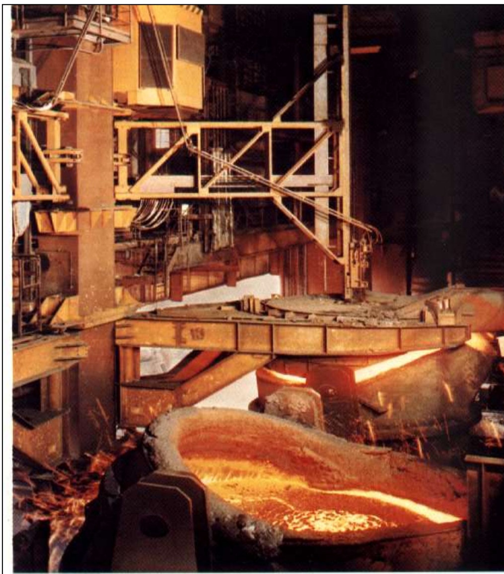
Figura 5.8 – Vista parcial de uma instalação de pré-tratamento do gusa, em escala industrial
