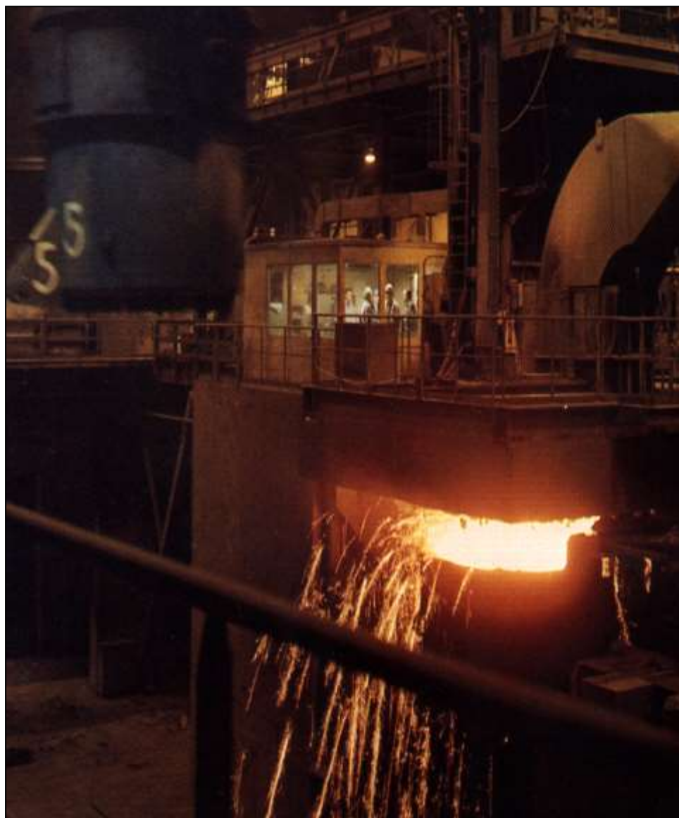
Figura 5.9 – Vista da panela de pré-tratamento do gusa durante a injeção de reagente
