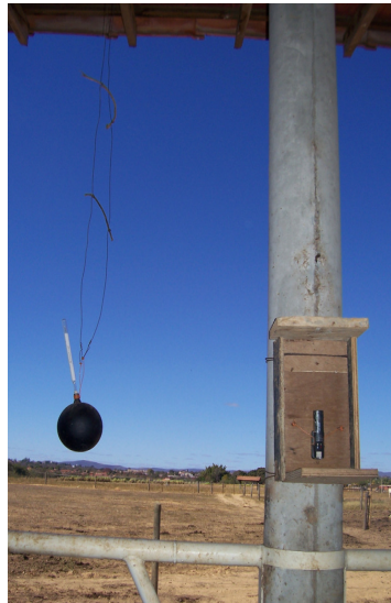
FIGURA 4 - Equipamentos meteorológicos na parte interna da instalação evidenciando o datalogger e o globo negro Fonte: Elaborada pela autora, 2010.
