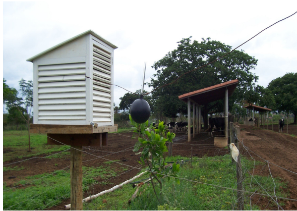
FIGURA 3 - Abrigo meteorológico e globo negro, localizados próximo a instalação onde ficam os animais na Fazenda Experimental. Fonte: Elaborada pela autora, 2010.
