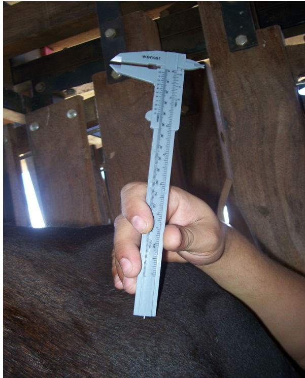
FIGURA 1 - Avaliação da espessura do pelame, usando paquímetro. Fonte: Elaborada pela autora, 2010.
