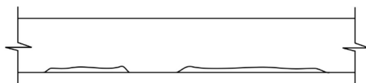
Figura 16 - Típica forma de fissuras e lascamento em viga de concreto, paralela às armaduras inferiores. Geralmente estas fissuras são acompanhadas pelo destacamento da camada de proteção.
