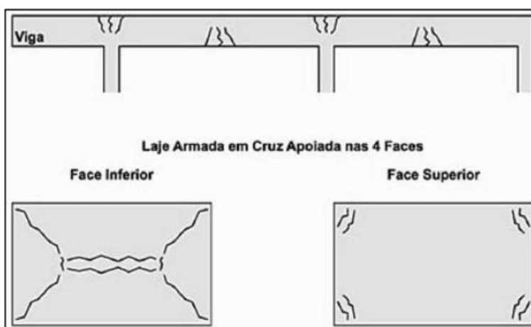
Figura 8 - Trincas de flexão em elementos de concreto armado.
