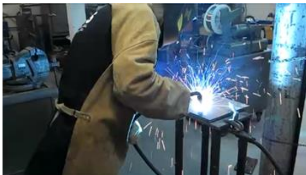
FIG.3 – Solda sendo executada pelo processo FCAW
