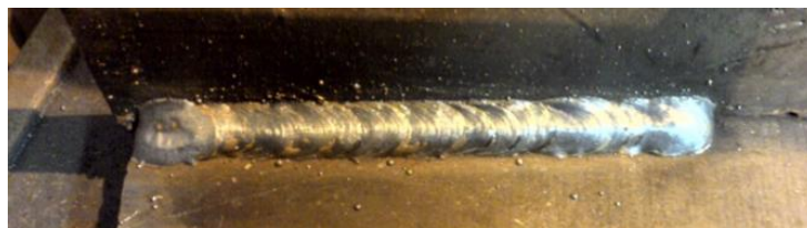
FIG.2 – Cordão de solda pelo processo de soldagem GMAW
