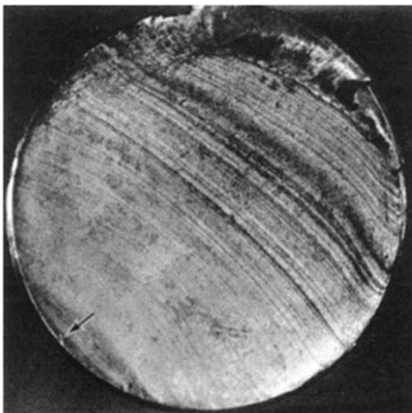
FIG.31 - Superfície de fratura de fadiga mostrando marcas de praia e origem da fratura. (KOU, Sindo, Welding Metallurgy, 2002, p.132).
