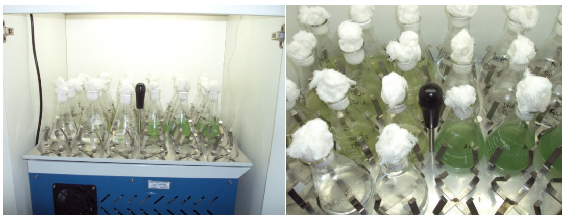
Figura 19. Fotos da montagem de um experimento típico, realizado sob temperatura controlada, agitação constante e foto-período de 12 horas.
